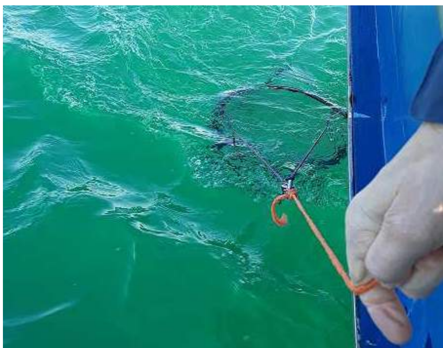
Figura 3 – Traino del retino lungo la colonna d'acqua per la raccolta del fitoplancton
