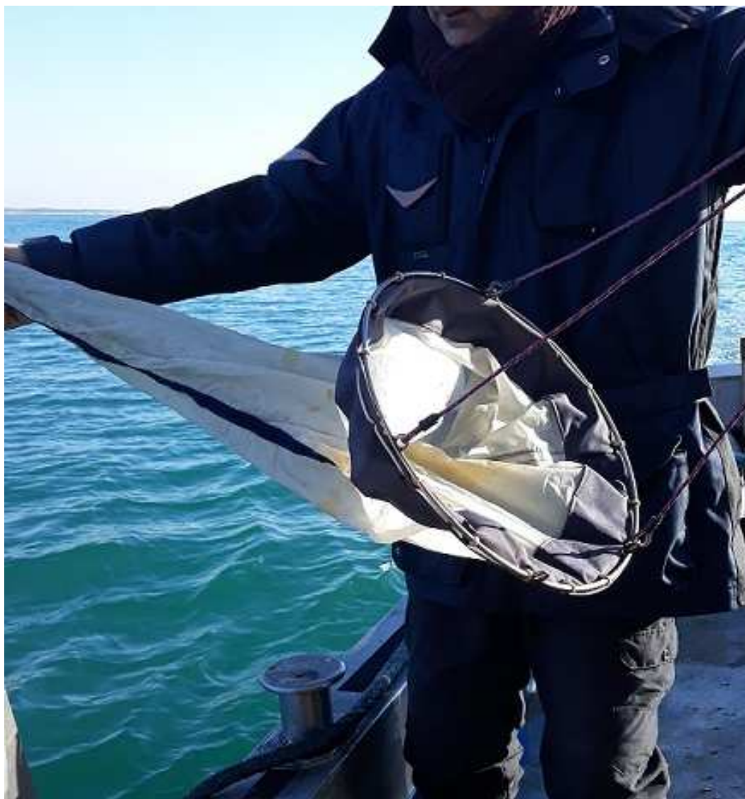
Figura 1 – Retino per il campionamento del fitoplancton
