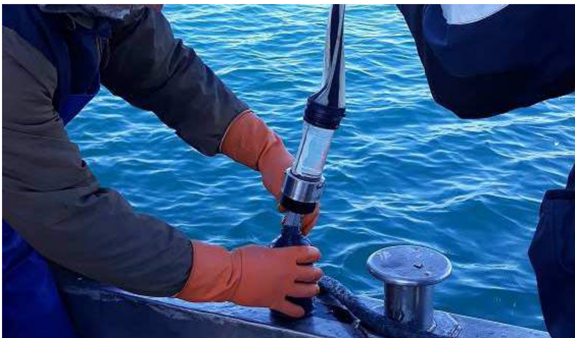
Figura 4 – Svuotamento del contenuto del retino nella bottiglia idonea al trasporto del campione in laboratorio
