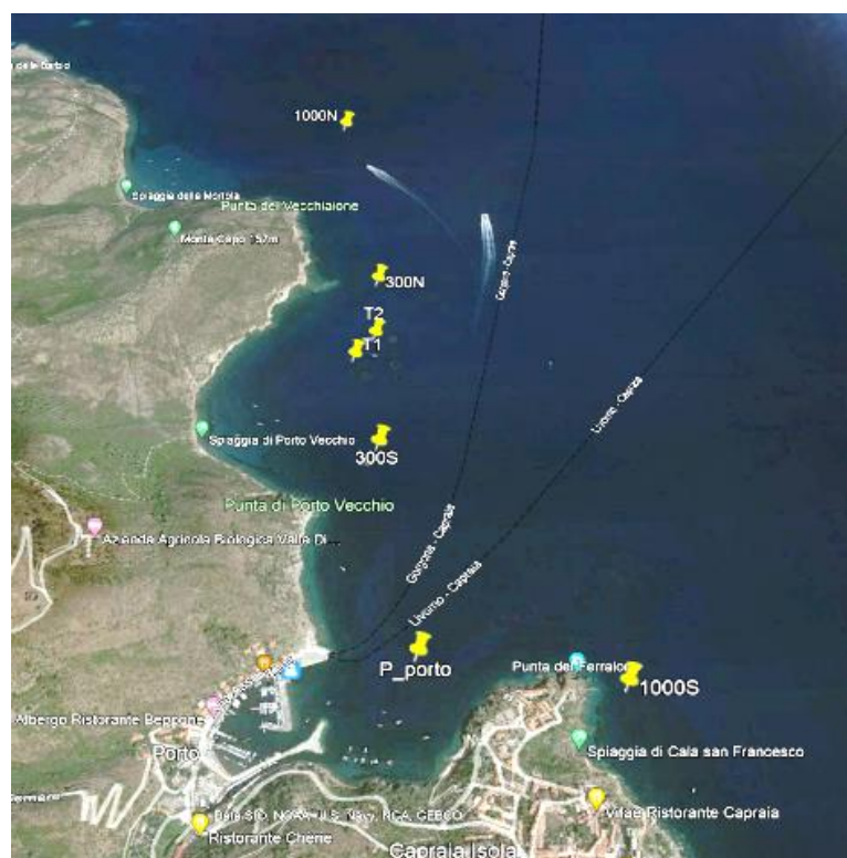
Figura 7, Individuazione grafica dei punti di controllo per l'estrazione dei risultati del modello numerico, le cui coordinate sono riportate in Tabella 5.
