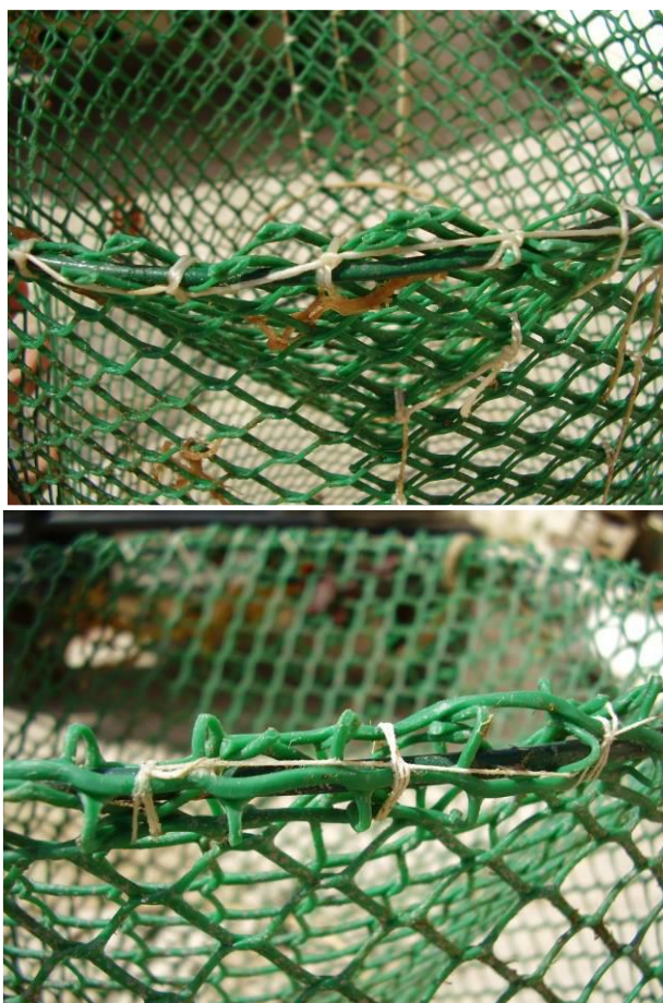
Fig.18 – Particolari dei filo Ingeo e Lyocell in prossimità dell'inganno dopo la sperimentazione in mare
