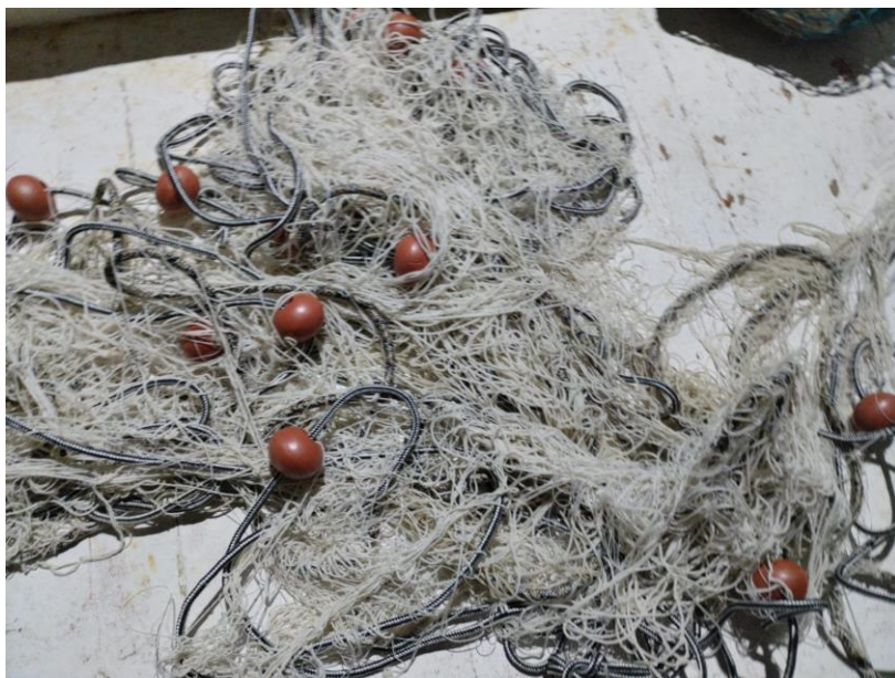
Tratto di rete con panni biodegradabili
