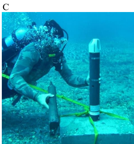
Fig. 13 –Modalità di funzionamento del correntometro (A); Profiler ancorato al corpo morto prima della messa in opera (B); Posizionamento dello strumento correntometrico sul fondale (C).
