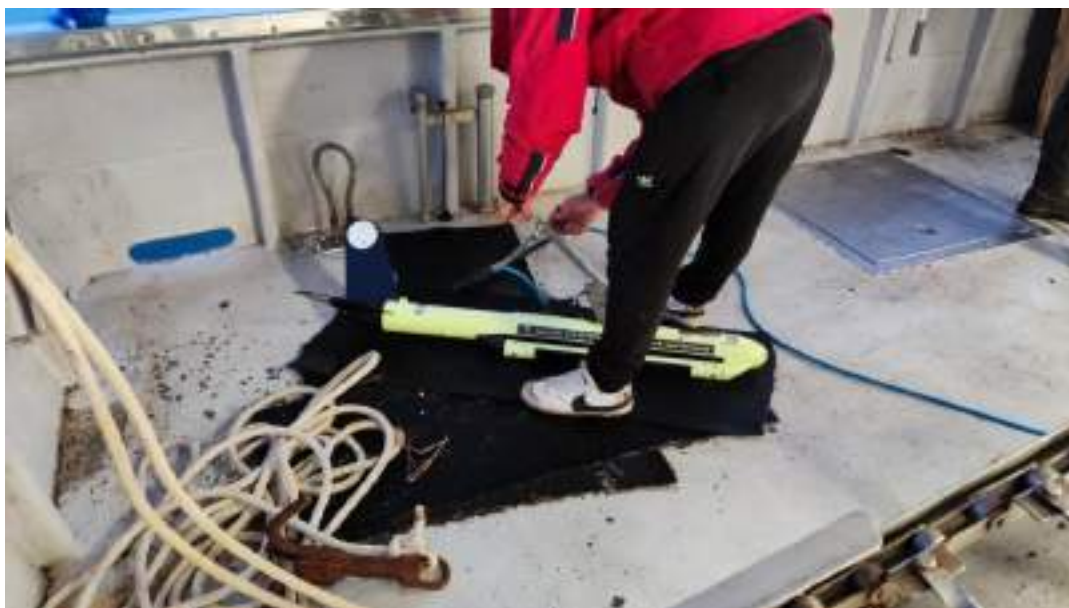
Figura 5: Preparazione dell'unità subacquea Tow-Fish (o pesce) collegata al cavo di traino
