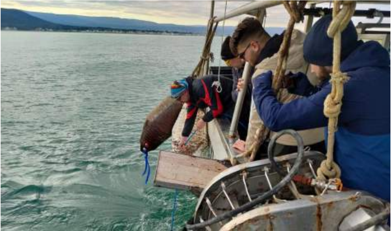
Figura 6: Immersione dell'unità subacquea Tow-Fish in mare
