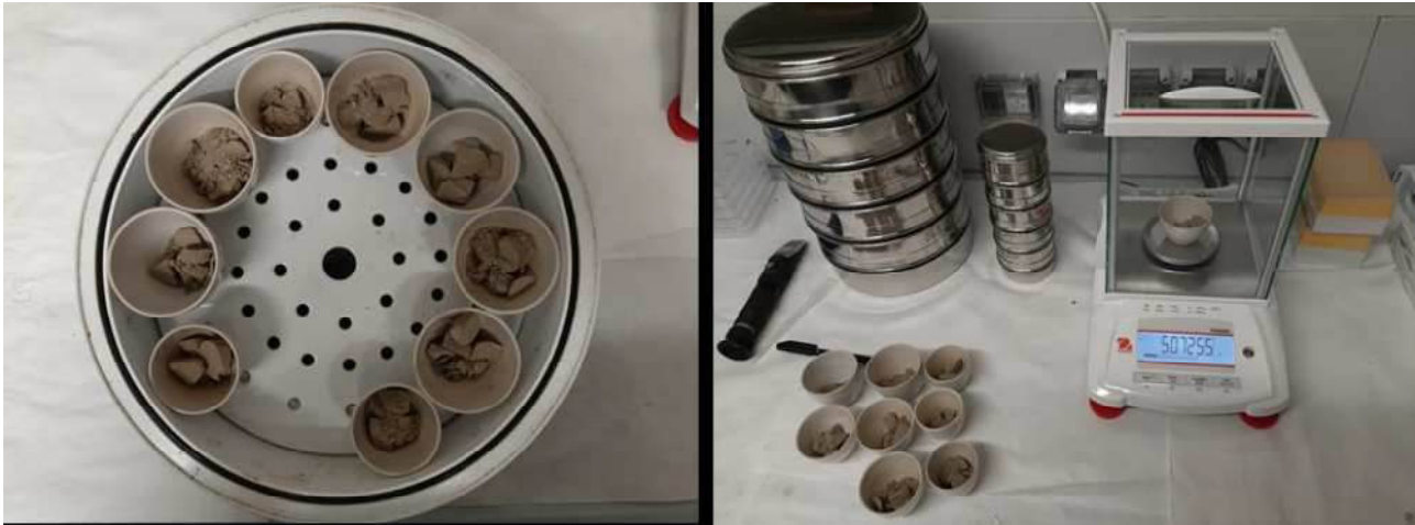
Figura 11 Analisi della sostanza organica attraverso la combustione in muffola dei campioni
