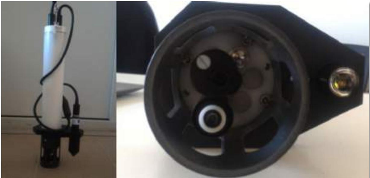
Fig. 2.1.3.C – Sonda Multiparametrica CTD *Idronaut Ocean Seven 310 Plus* e turbidimetro.
