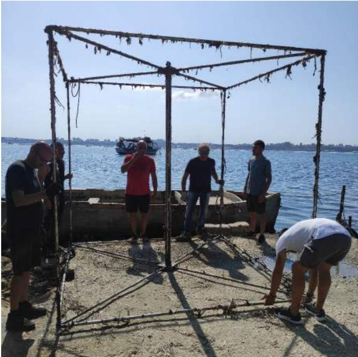
Fig. 2.1.4.D – Recupero della struttura metallica su cui erano fissati i collettori.
