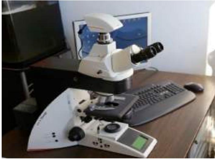
Microscopio per l'analisi istologica, oltre che per l'analisi dell'immagine computerizzata.
