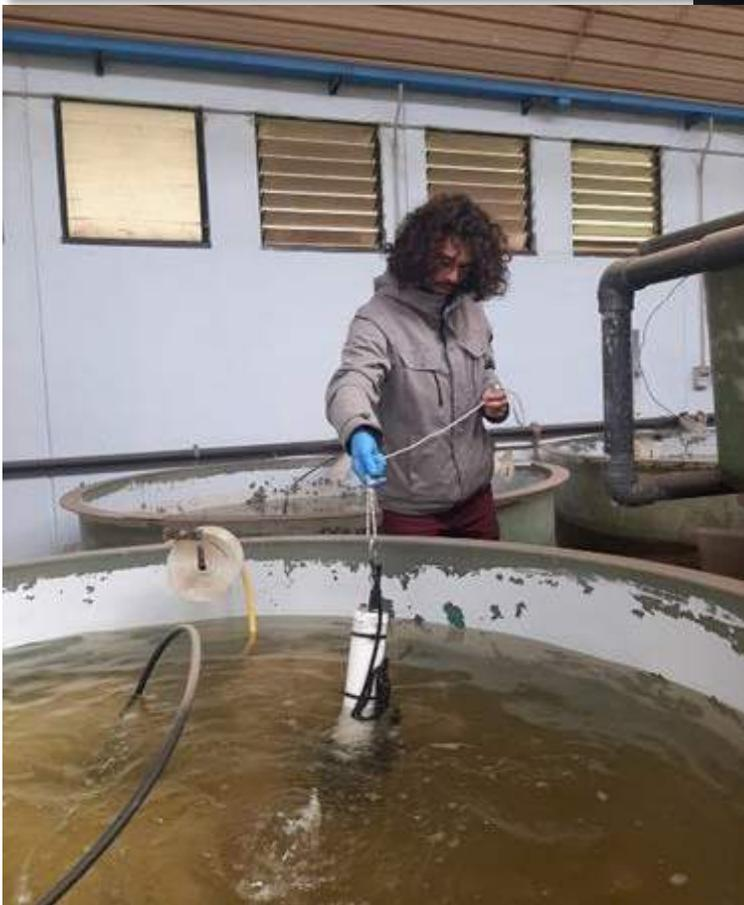
Fig. 2.2.2.A – a) Cassette per l'ubicazione in vasca dei 32 riproduttori; b) Collocazione dei collettori in corrispondenza dei bordi della vasca di stabulazione; c) Impiego della sonda multiparametrica CTD per il monitoraggio delle acque della vasca di stabulazione.
