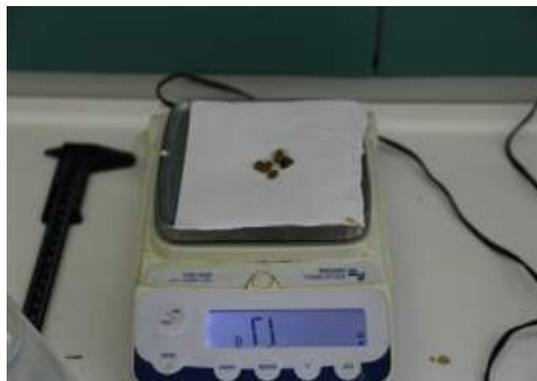
Calibro di Vernier (sx) e bilancia analitica (dx) per il rilievo dei dati biometrici di esemplari di riccio di mare *Paracentrotus lividus*.
