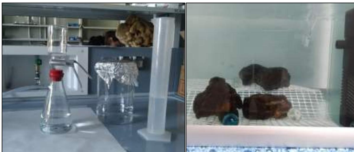
Figura 2.2.A. Apparato di filtrazione, montato con filtro  $0,22\text{ }\mu\text{m}$ , utilizzato per filtrare l'acqua marina sintetica (AMSF) adoperata durante gli esperimenti (sinistra); alcuni degli esemplari di *S. spinosulus* durante la fase di stabulazione in laboratorio (destra) (foto di R. Trani).
