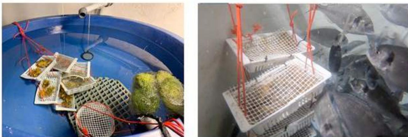
Figura 3.4.D – Vasca sperimentale con biorisanatori: spugne (*H. perlevis*), policheti (*S. spallanzanii*) macro-alga (*C. linum*).
