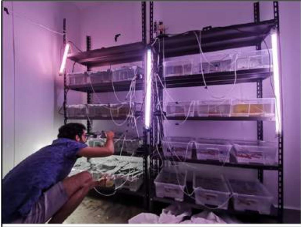
Figura 2.1.A – Allestimento dei 24 acquari in camera termostata.
