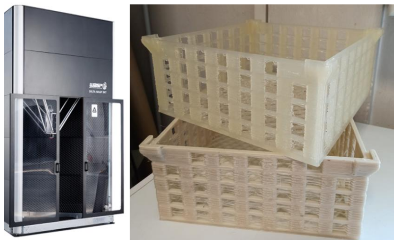
Fig. 4: Stampante 3D utilizzata in Wasp e le due tipologie di cassette costruite
