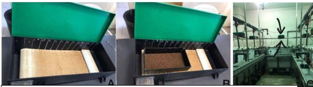
Mangiatoia automatica e posizione sopra le vasche
