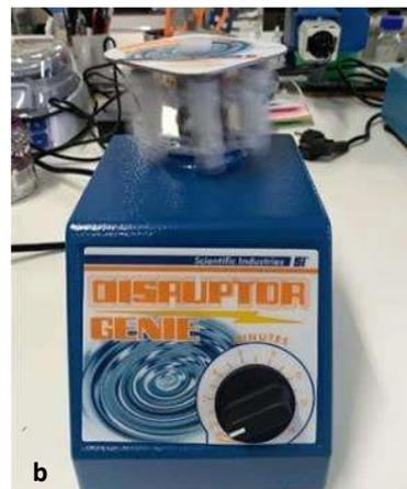
Figura 2(a) Campioni nelle provette con le biglie e (b) Disruptor Genie, strumento per la rottura dei campioni difficili
