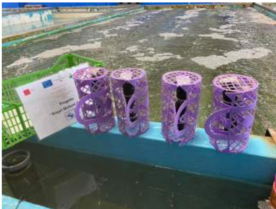
Figura 40- Contenitori con biosensori attaccati a mitili e posti presso il centro di depurazione molluschi CIMAR
