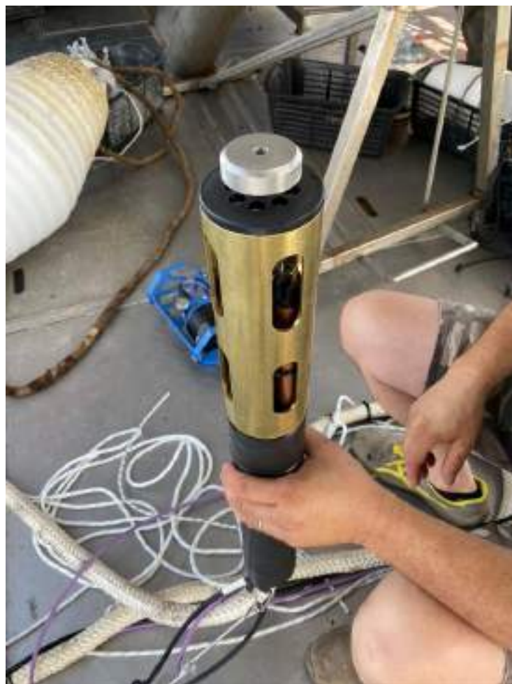
Figura 28- Predisposizione della sonda multiparametrica da agganciarsi al sistema di monitoraggio
