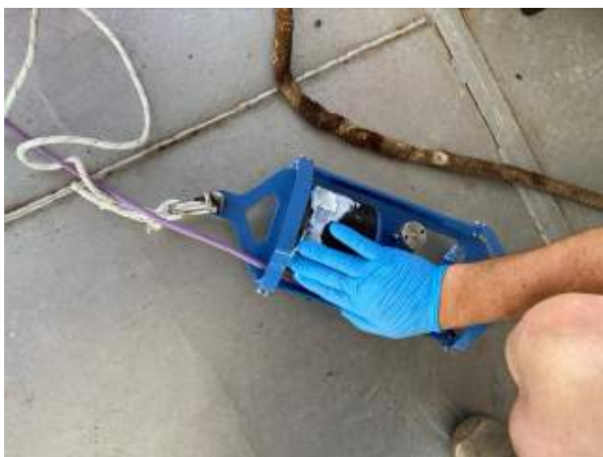
Figura 29- Predisposizione del correntometro da agganciarsi al sistema di monitoraggio e apposizione della crema con funzione antifouling.
