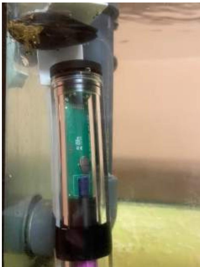
Figura 38- Biosensore in funzionamento in acqua con il mitilo con le valve aperte
