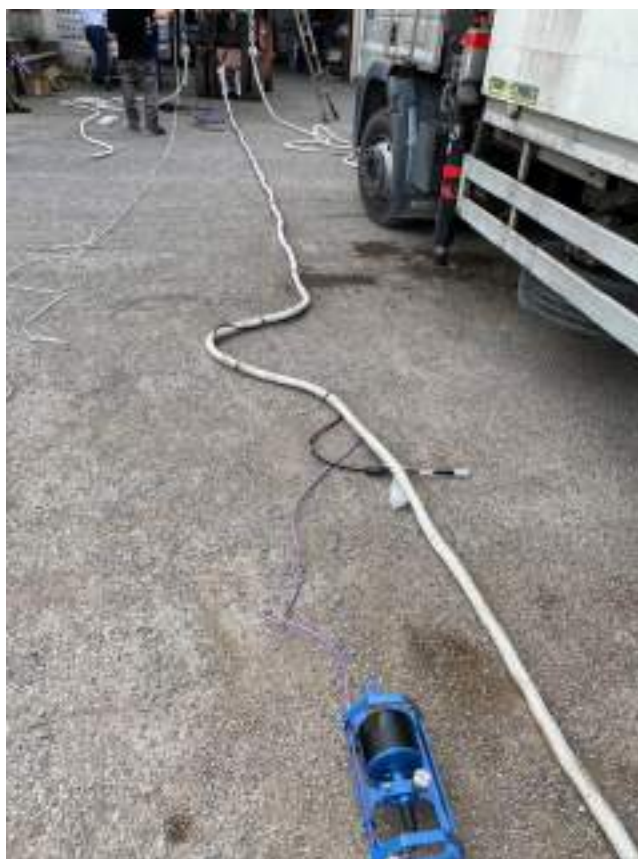
Figura 24- Correntometro fissato al tirante centrale. Si scorge, a poca distanza, il connettore per la sonda e, sul fondo, gli altri due elementi di fissazione della boa.
