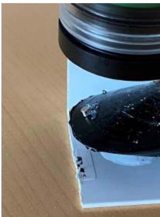
Figura 37- Particolare del magnete incollato al mitilo attaccato alla staffa con colla per acquariologia e posto nelle vicinanze del biosensore
