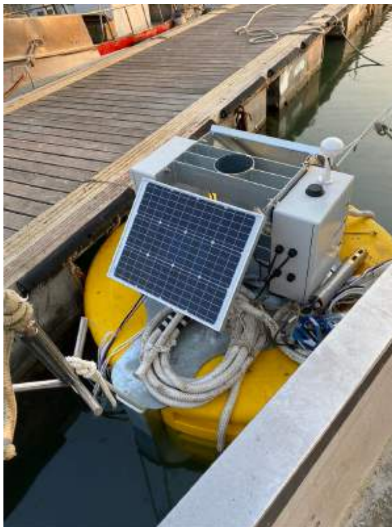
Figura 32- Sistema di monitoraggio allestito presso il proto di Giulianova. Si notano la sonda e il correntometro già predisposti.
