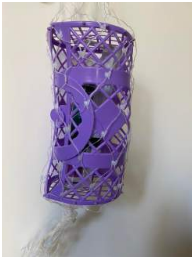
Figura 36- Contenitore in plastica con all'interno il complesso staffa più biosensore contenuto in calza di rete per molluschicoltura
