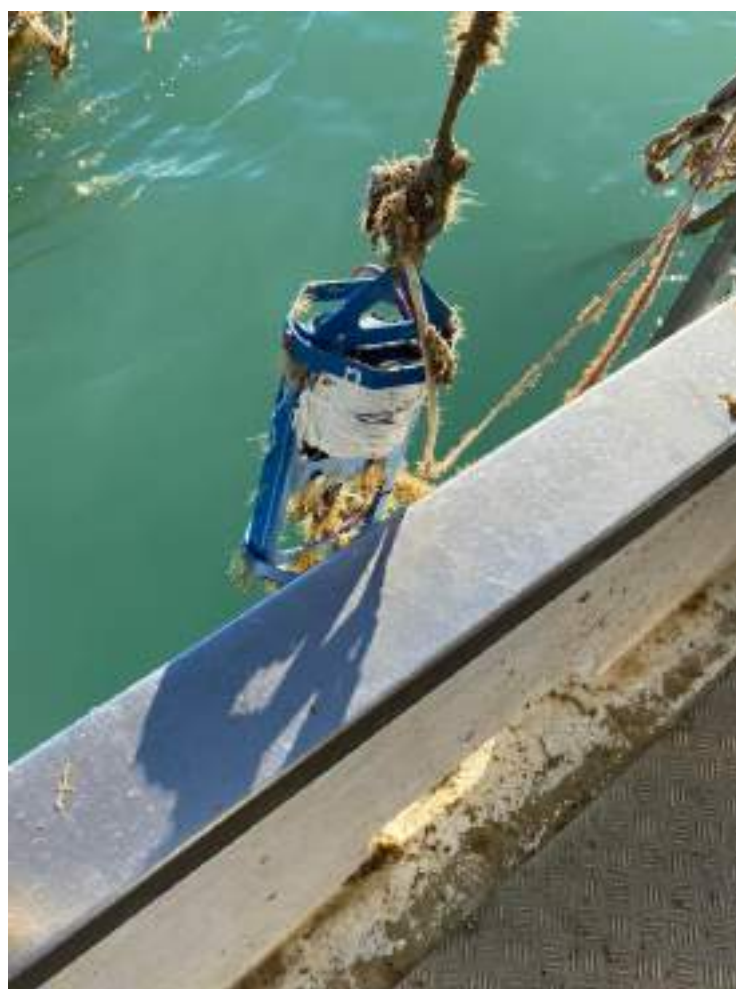
Figura 34- Correntometro del sistema di monitoraggio presso Adriatica off-shore: si nota l'accumulo di fouling sul correntometro dopo due mesi di permanenza in mare
