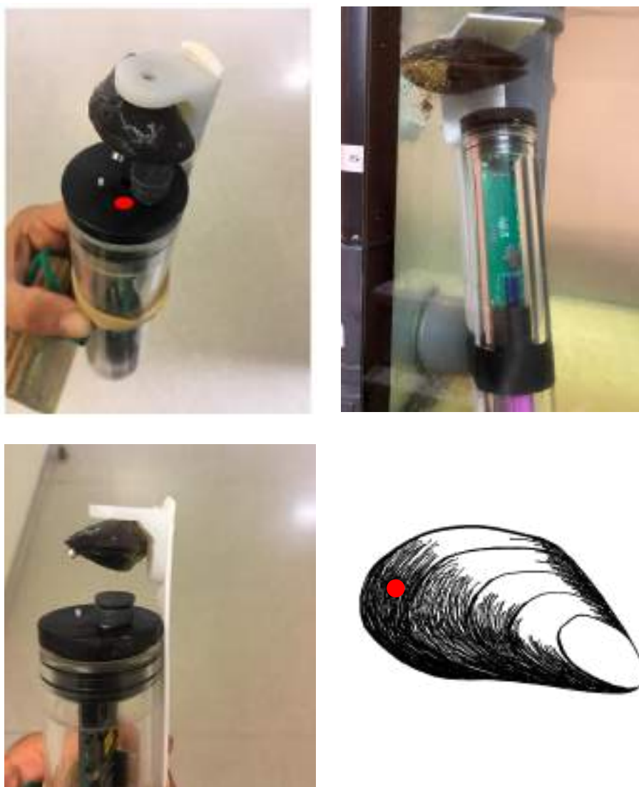
Figura 42- Struttura del biosensore e punto di collocamento corretto del magnete
