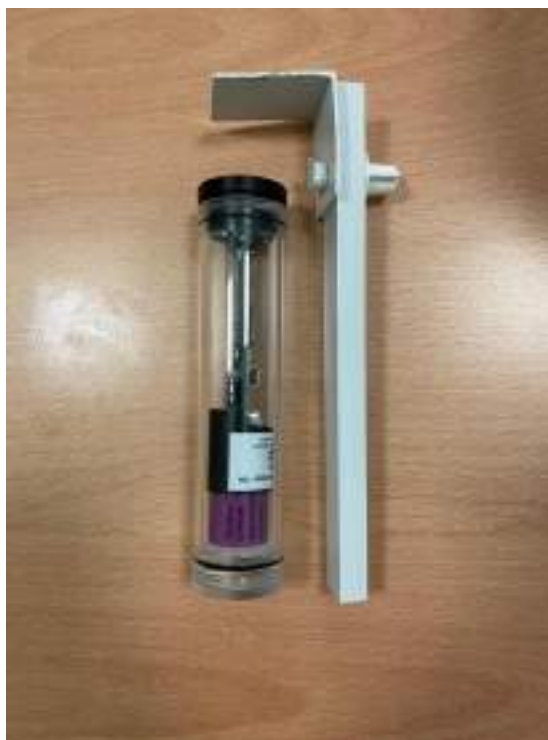
Figura 35- Biosensore con staffa porta mitilo specificatamente costruita
