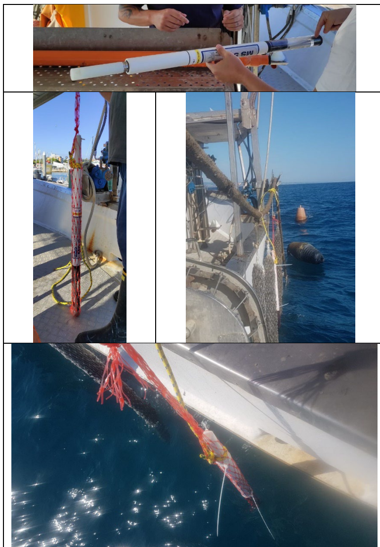
Figura 3. Posizionamento della sonda multiparametrica per l’acquisizione in continuo dei parametri chimico-fisici.
