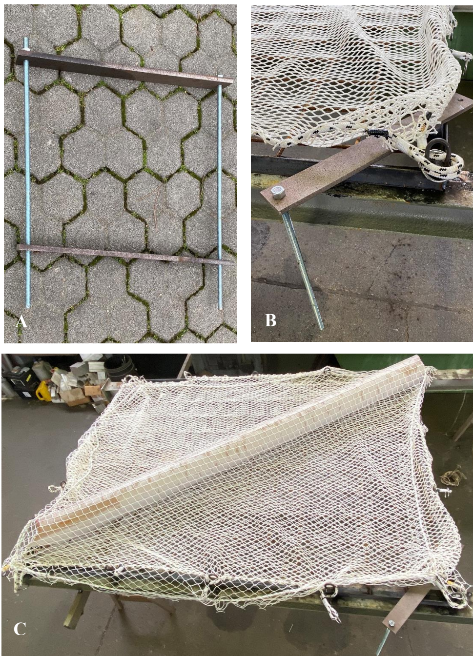
Figura 21- A- Traversine in acciaio al carbonio con profilo piatto di 40x6 e tiranti filettati con dadi di 12 mm di diametro. B-Dettaglio della traversina. C- Posizionamento rete di ammantamento e traversina in acciaio.
