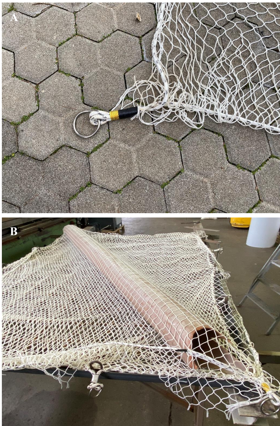
Figura 20- Fotografie rappresentati le vele di ammanto predisposte nell'ambito della presente attività di progetto. A- Dettaglio dell'anello perimetrale. B- Dettaglio del posizionamento sui telai. Notare la differenza di grandezza delle maglie (35x35) rispetto a quelle delle vele precedenti (20x20) (Fig. 19).
