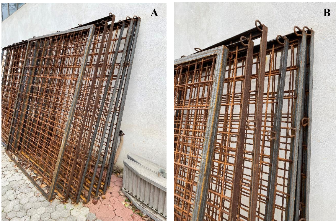
Figura 18 A e B- Fotografia relativa ai telai di metallo posti in essere nell'ambito della presente attività. Notare, nell'immagine B, il dettaglio delle ritenute ad anello saldate sull'angolare della struttura.
