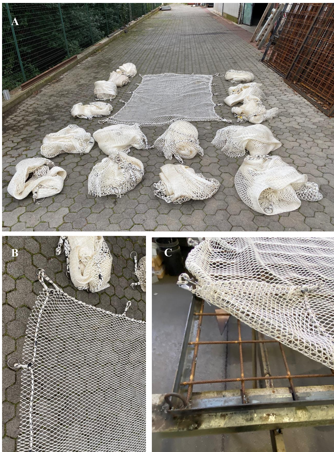
Figura 19- Collage di foto raffigurante le vele messe a punto nel corso della presente attività di progetto. A- Fotografia delle 16 vele 20x20 predisposte per il posizionamento sui telai. B- Ingrandimento del dettaglio delle maglie e degli anelli perimetrali. C- Dettaglio di posizionamento della vela sul telaio. Notare il reticolato del telaio in metallo e i relativi anelli perimetrali.
