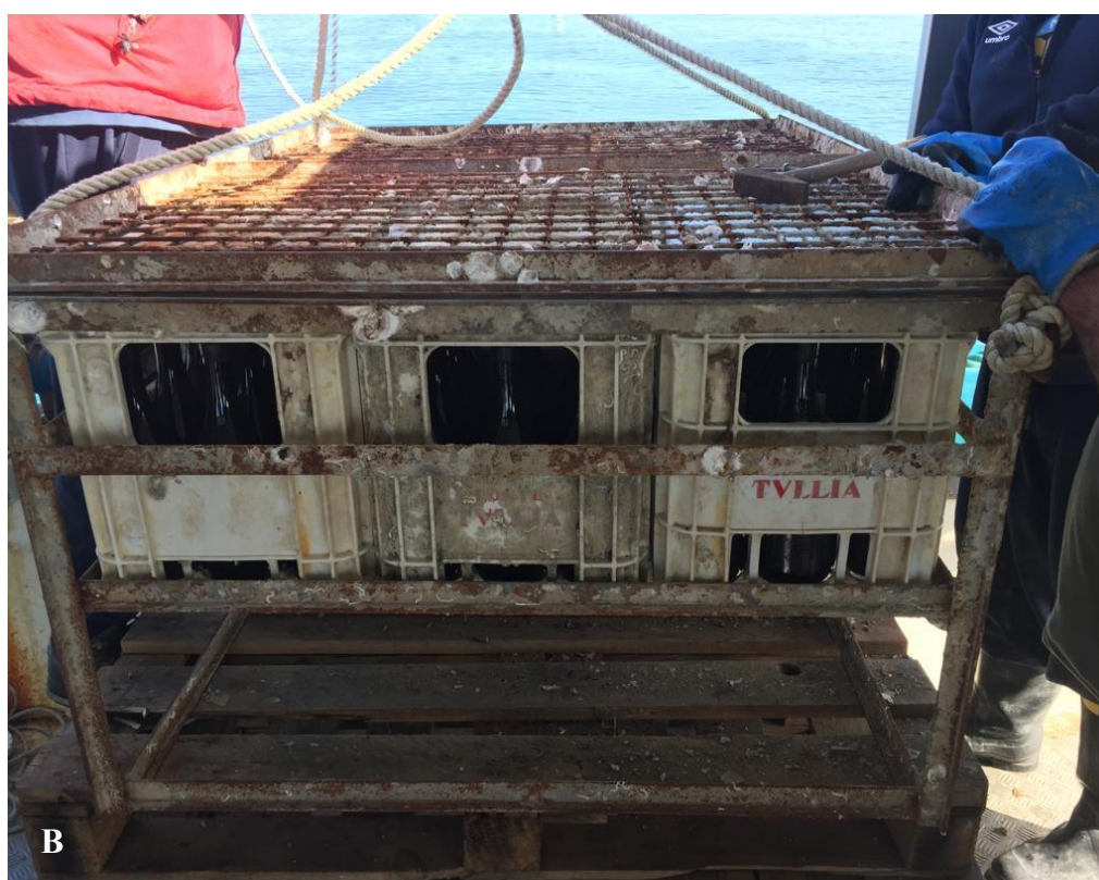
Figura 43- A- Dettaglio delle cassette impiegate per la messa a dimora del vino. Notare la retina apposta su una parte delle bottiglie di vino per verificare un migliore attecchimento del biofouling . B-Dettaglio delle cassette impiegate per la messa a dimora delle birre.
