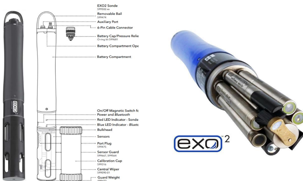
Figura 14- Rappresentazione schematica della struttura di base della sonda multiparametrica impiegata nell'ambito del presente progetto. I sensori costituiscono strutture di forma cilindrica collocate nella parte inferiore dello strumento e opportunamente calibrate mediante Software Kor® .
